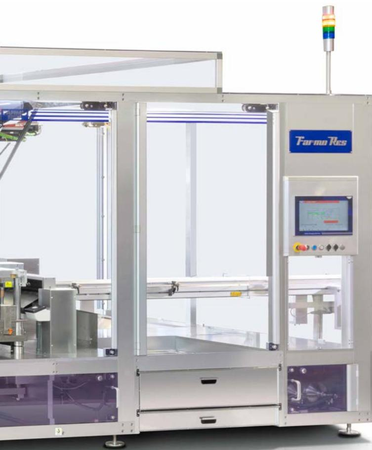
La Farmo Res Prima K7 è una formatrice automatica per la produzione di vassoi in PET, PVC e polistirolo per il confezionamento di siringhe, fiale e flaconi, che integra a bordo alcuni robot Delta Autonox24 distribuiti in Italia da DCM
