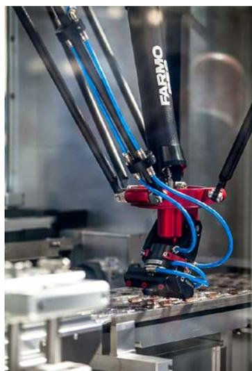
Vista del sistema di caricamento flaconi.
